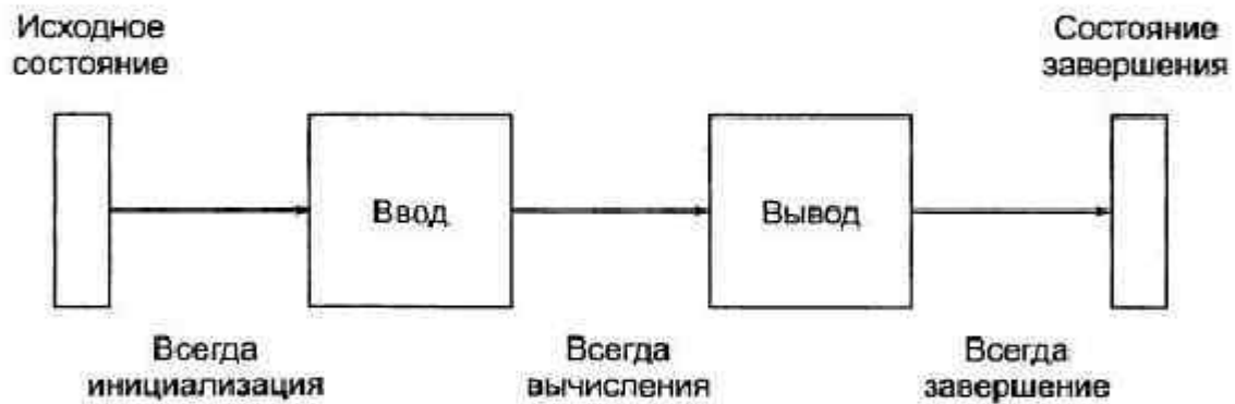
Рис. 3.20. Диаграмма переходов состояний программного обеспечения, активно не взаимодействующего с окружающей средой
